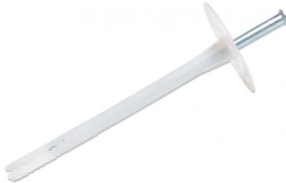
Rys. 2. Przyjęty łącznik mechaniczny – średnica całkowita łącznika 10mm, średnica rdzenia ze stali ocynkowanej 8mm, długość 200mm, w tym 50 mm zakotwienia
