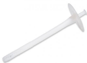
Rys. 4. Przyjęty łącznik mechaniczny – średnica całkowita łącznika 10mm, średnica rdzenia z polipropylenu 6mm, długość 150mm, w tym 50 mm zakotwienia
